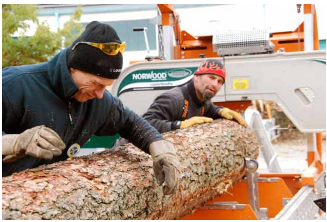
Eine leichte Übung für die Logosoler Ralf Hartmann (vorne) und Volkert Hummel: Der Lärchenstamm für die neue Terrasse von Ralf ist mit dem neuen LMPPro von Logosol schnell aufgeschnitten.
