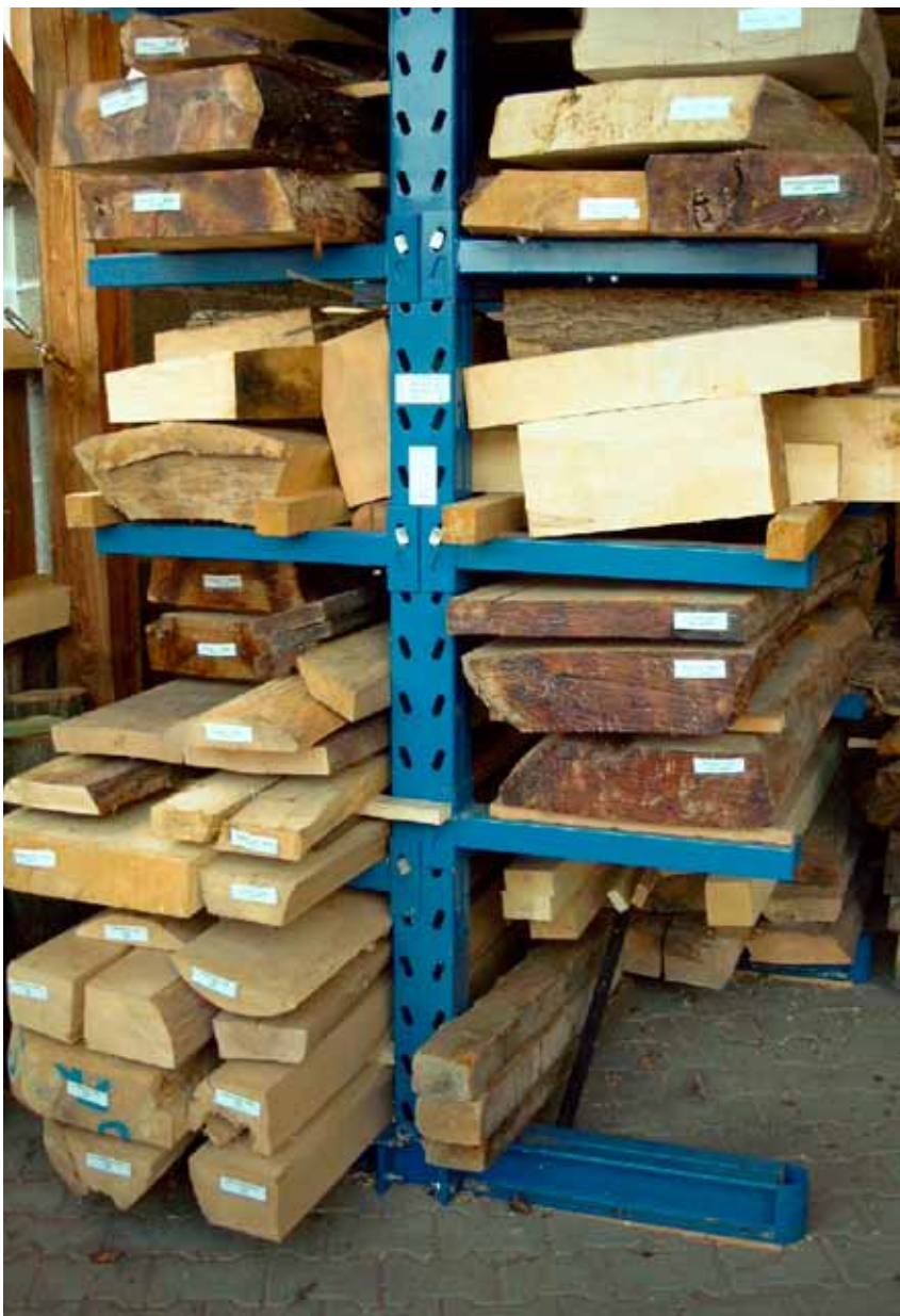
• Die Königin für die Lageristen ist das Kragarmregal. Holz kann hier sicher, übersichtlich, gleichmäßig umlüftet eingelagert und auch leicht wieder ausgelagert werden.
